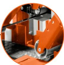
Sistema hidráulico de tensión de la sierra centralizado.
