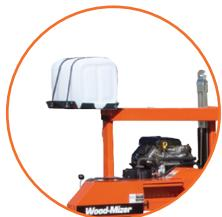
Lubricación automática de la sierra por gravedad (18 L) y rodillos guía.
