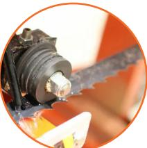
Sierra de 447 cm con rodillos guía y lubricación por válvula manual.
