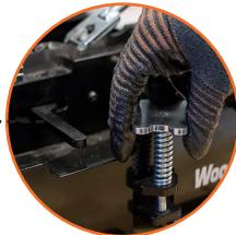
Ajuste mediante una sola perilla para afilar sierras de 1" a 1-1/2" de ancho.
