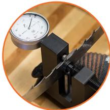
Medidor de triscado de dientes para asegurar un ajuste uniforme y preciso.
