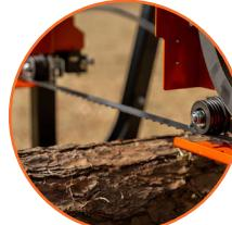
Guías de rodillo de alto desempeño y Sistema de lubricación de la sierra por gravedad.
