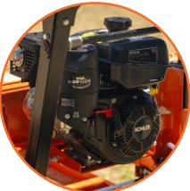
Motor de gasolina Command Pro 9.5 HP con filtro Quad-Clean™.
