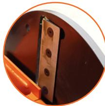
Apertura máxima de astilladora hasta 150 mm de diámetro.
