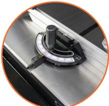
Guía transportadora (miter gauge) de -45° a 45° para cortes angulares.
