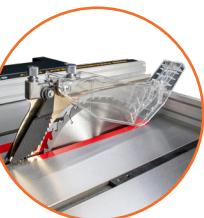
Cubierta de seguridad ajustable con sistema antirretorno, cuchilla separadora y protector de disco.
