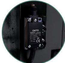
Interruptor de límite momentáneo de tipo émbolo para un Ajuste digital de espesor con alta precisión
