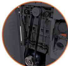
Sistema de tracción por polea que optimiza la transmisión de fuerza y durabilidad.
