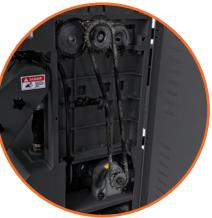
Sistema de elevación mediante cadena para un movimiento seguro y eficiente.
