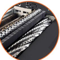
Equipada con dos cabezales helicoidales con 144 cuchillas c/u que garantizan un corte uniforme en cada pasada.
