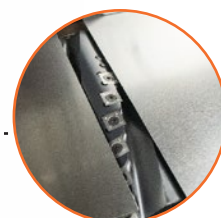
Cabezal de cuchillas helicoidales de carburo intercambiables y giratorias a 4 posiciones.
