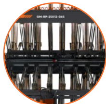
6 prensas hidráulicas por sección.
