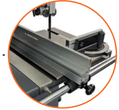
Inclinación de mesa de -5° a 45° para cortes a escuadra y cortes angulados
