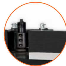
Diámetro de la flecha portaherramientas de 35 mm
