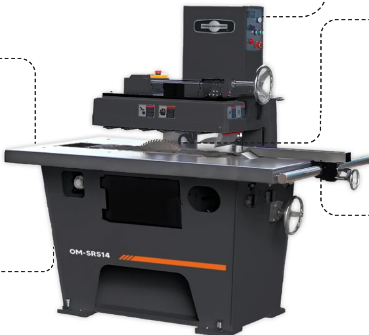
Rango de diámetro exterior del disco de corte 255 mm (10") a 355 mm (14")
