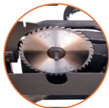
Disco de corte con diámetro exterior de 305 mm (12")
