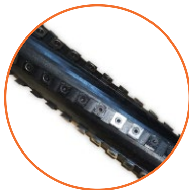
Cabezal de corte con 68 cuchillas, 4 filas de 17 cuchillas helicoidales de 15 mm x 15 mm x 2.5 mm.
