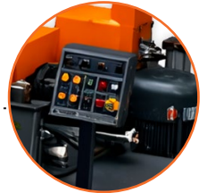
Panel de control industrial con botones de seguridad, y monitoreo completo de motores, sistema hidráulico y conveyors
