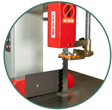
Guía de sierra con rodamientos para cortes precisos
