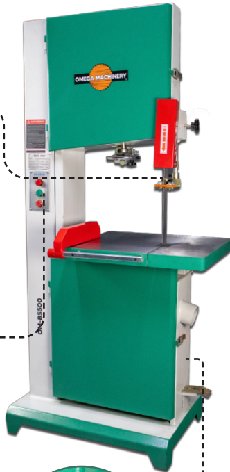
Guía de sierra con rodamientos para cortes precisos
