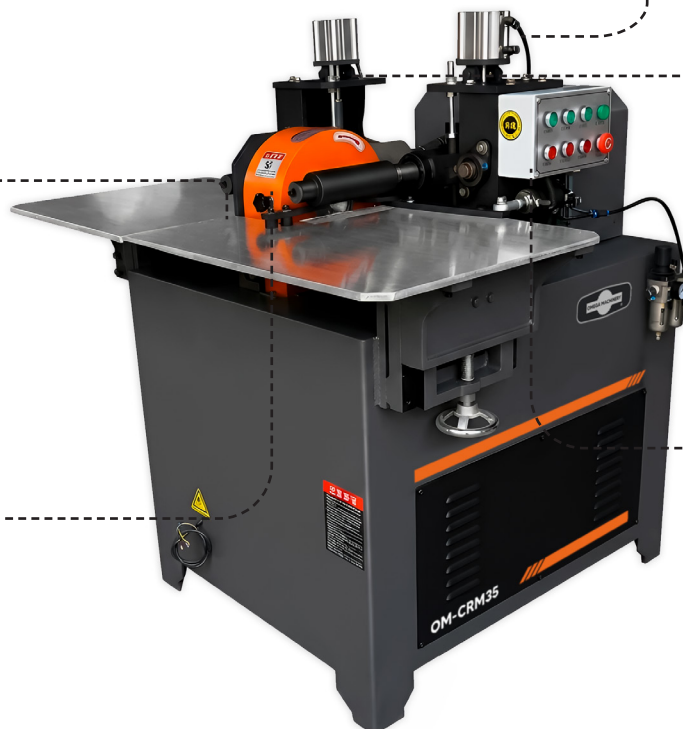
Rango de diámetro de corte de 20 mm a 35 mm para diferentes medidas de palos redondos
