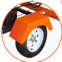
Chasis tipo remolque con llantas 165/70R13
