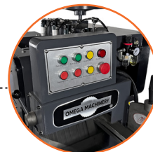
Panel de control frontal con botones de encendido y paro, para un control seguro y eficaz
