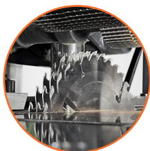
Discos de corte ajustables que permiten configurar múltiples anchos de corte
