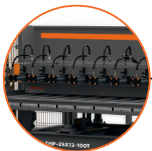
Prensado vertical con platos calientes horizontales
