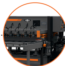
Capacidad de prensado de 100 toneladas en vertical
