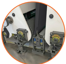
Rodillos balanceados, para evitar marcas irregulares tipo "S"
