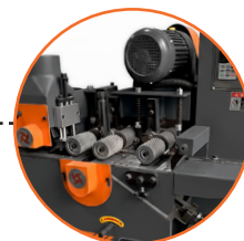
Dos ejes porta cuchillas con motores de 10 HP cada uno
