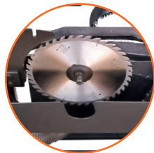
Disco de corte con diámetro exterior de 305 mm (12") a 315 mm (12-1/2")
