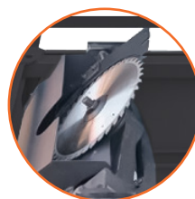
Sierra ajustable con inclinación de la sierra 0° a 45°
