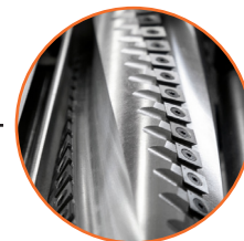
Cabezal de corte helicoidal de 97 mm de diámetro con 4 ranuras de 72 cuchillas de 15 mm x 15 mm x 2.5 mm
