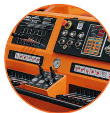
Panel de control del operador estacionario, integrado al control hidráulico
