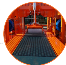
Velocidad de alimentación 4 a 15 m/min
