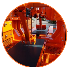
Sistema cuádruple de cabezales ajustables
