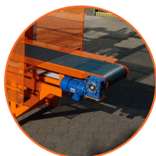
Altura del conveyor 86 cm
