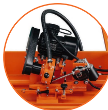
Motor principal eléctrico de 0.55 kW (3/4 HP)
