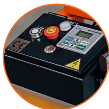
Equipado con programador MLC-02 para controlar el número de dientes triscados
