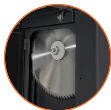
Disco de corte de 18" eficaz para realizar cortes simultáneos en tablas de gran tamaño y grosor
