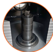
Diámetro de la flecha portaherramientas de 30 mm
