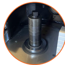
Diámetro de la flecha portaherramientas de 30 mm
