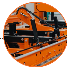
Rodillo nivelador, girador de troncos, prensa hidráulica y 5 soportes laterales
