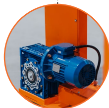
Motor del conveyor integrado para transmisión directa
